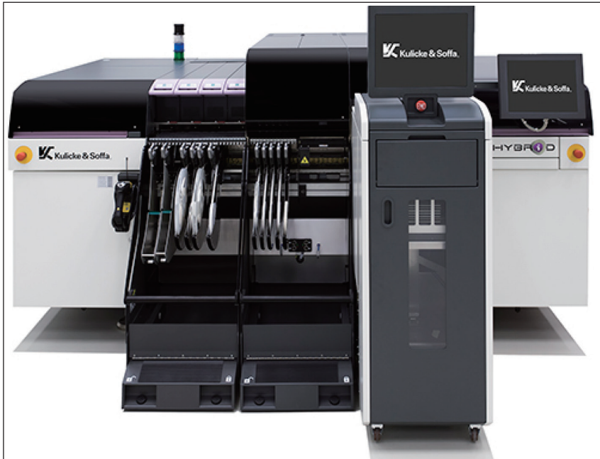
圖：K&S 最新 Hybrid 三合一晶圓進料設備，可用於嵌入式元件、PoP/SiP 或被動 SMD 封裝
