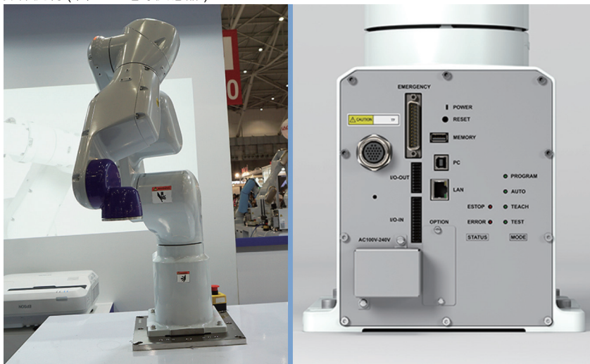
圖 3：Epson VT6L 六軸機械手臂內建控制器，設定簡易且 I/O 連線埠位置非常靠近夾治具，操作便利（含 24V 電源供應器）
