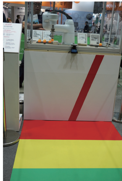
圖 7：DENSO「SAFETY MOTION」高速機械手臂可設定安全距離：綠色區域屬正常工作範圍，進入黃區機械手臂會放慢動作，紅區將暫停作業
