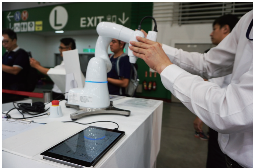
圖 6：DENSO「COBOTTA」協作機器人可搭配平板以簡單手勢訓練動作
