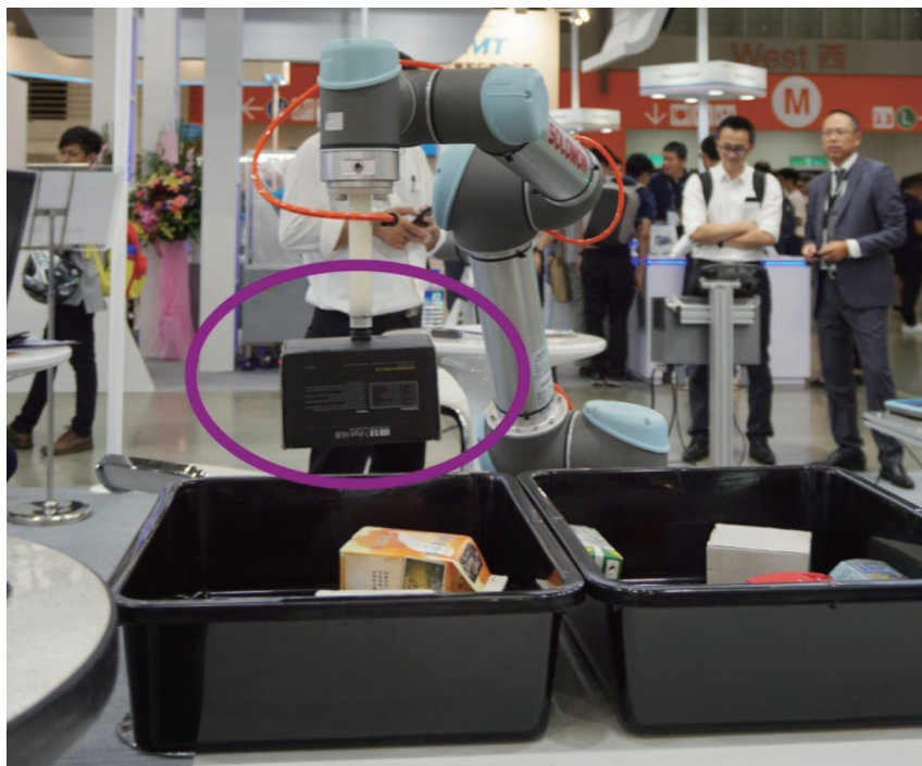
圖 5：UR 聯手所羅門展出的另一個亮點是以吸取取代夾具 (如紫色圈所示)，可因應不同形狀、材積、重量的物件，且取放速度更快
