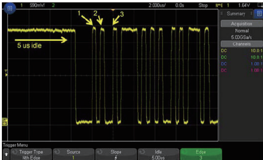
圖 9：使用「第 N 個信號緣叢發觸發」觸發數位叢發的第 3 個信號緣。
