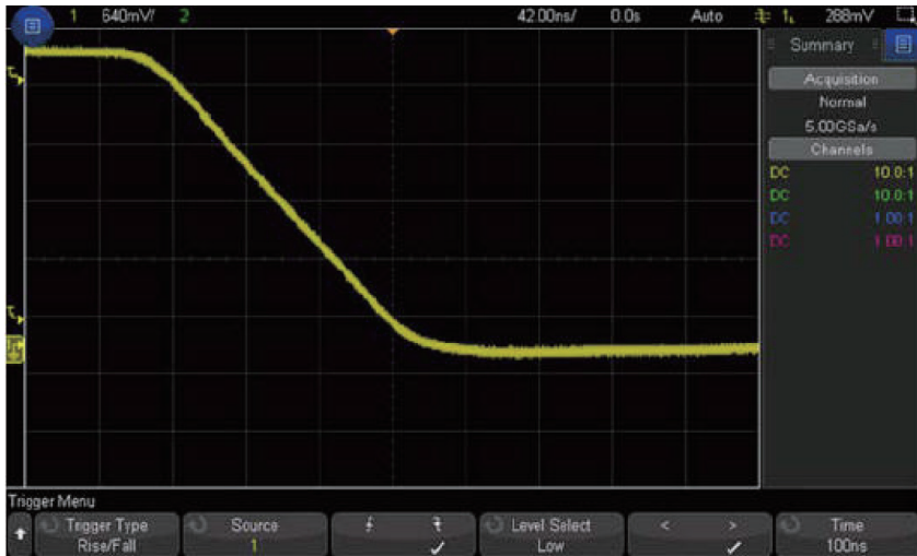
圖 3：使用「下降時間」觸發功能隔離慢速下降信號緣。
