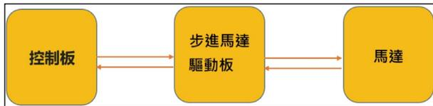
圖 14: TMC5130 與 Arduino Mega 2560 連接
