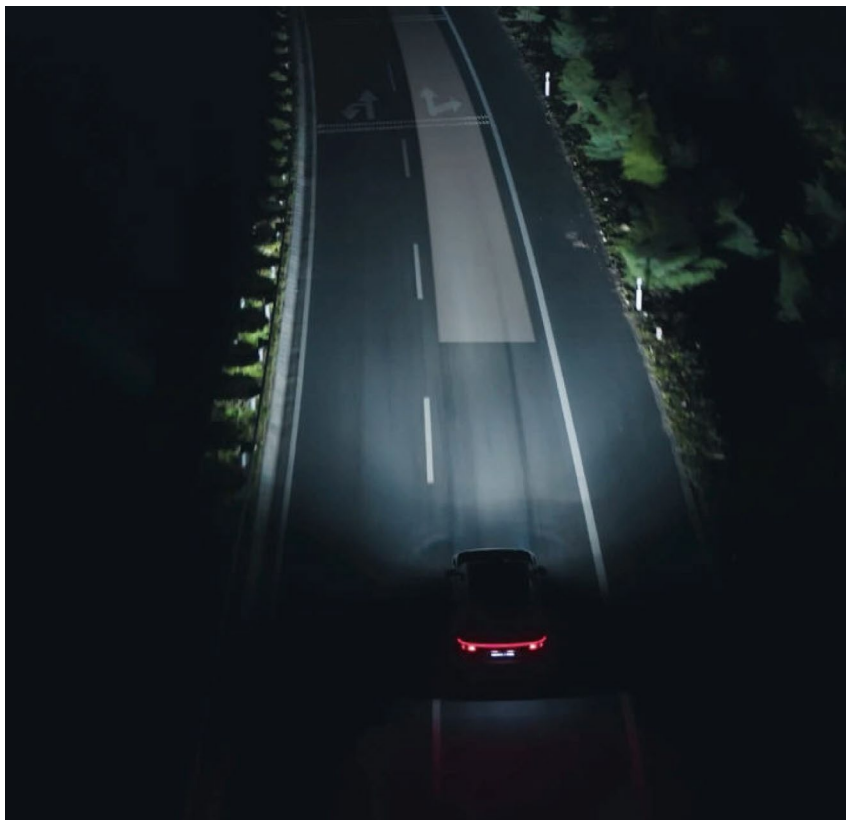
圖說：問界 M8 能隨光線、車速、轉向、路況，動態調節照明長度和寬度
