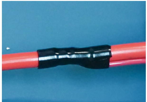
圖 22: 用束線帶機械地收緊連接
