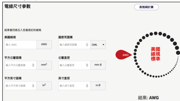
圖 4: DigiKey 導線 AWG 規格換算器
