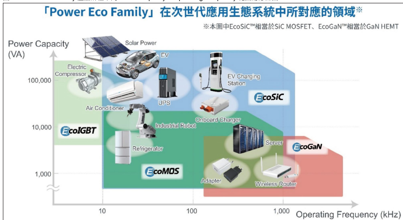
圖 1：Power Eco Family 產品群在不同 Power Capacity × Operating Frequency 範圍的分佈圖
