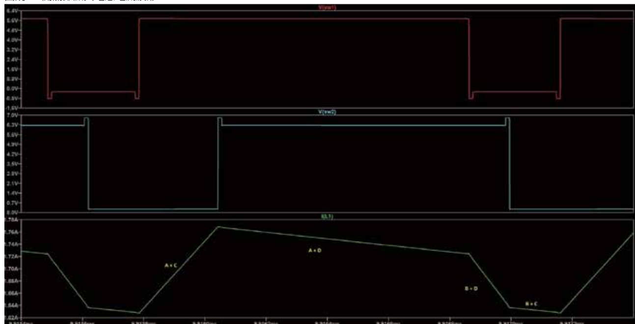
圖說 2：開關節點與電感電流波形
